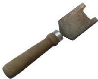
Рис. 21 Ключ для демонтажа заглушек
