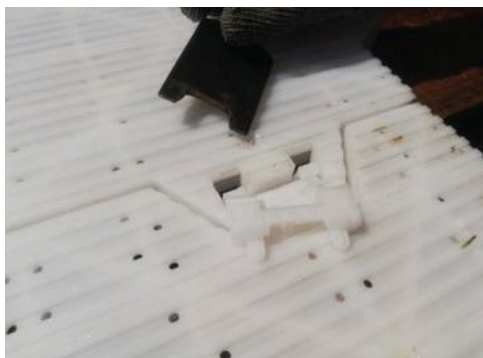
Рис. 23 Демонтаж фиксирующих заглушек ключом
