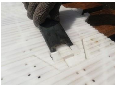
Рис. 23 Демонтаж фиксирующих заглушек ключом
