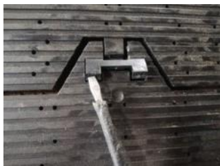
Рис. 22 Демонтаж фиксирующих заглушек отверткой
