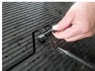
Рис. 22 Демонтаж фиксирующих заглушек отверткой
